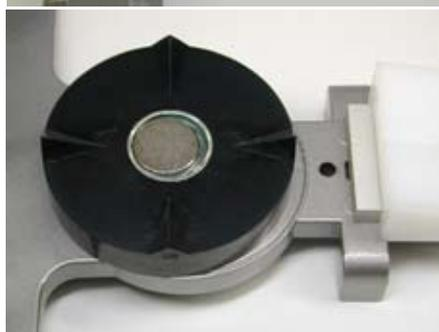
マウントプレート規制ネジ (4) の突出状態を加減して、プレート内面に付された溝 (3) の深さにより、プレートは前後のみに移動したり、全方向に移動・回転をさせることができる。
